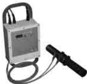
Saldatrice monovalente ad elettrofusione di facile utilizzo con inserimento in manuale dei tempi di saldatura. La saldatrice può essere utilizzata per la raccorderia ad elettrofusione +GF+ fino a un diametro di 500 mm - SDR 17. Utilizzabile per saldature di serie. L'unità memorizza l'ultima saldatura eseguita per rendere il lavoro ripetibile. Un segnale indica l'inizio e il termine del ciclo di saldatura.
